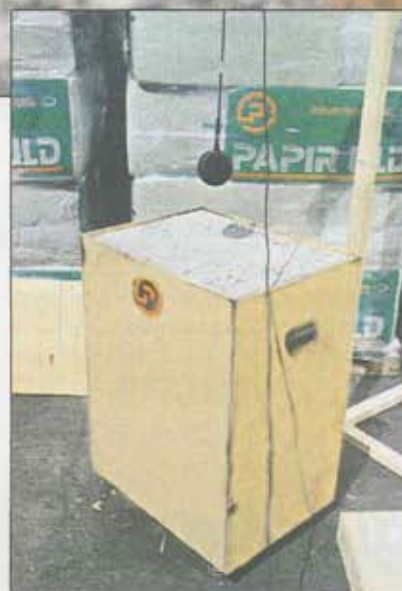
Lyd-målingerne blev udført i en lyd-isoleret kasse af krydsfiner beklædt med gipsplader, en håndværkerradio i bunden, der afspillede hvid støj, og en mikrofon anbragt 20 cm over 100 mm af testmaterialet i toppen. Kilde: Nordsjællands Akustik, juli 2010.
